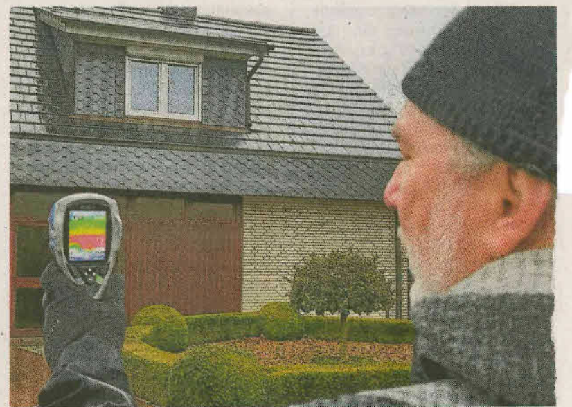
Matthias Wangelin schaut durch die Wärmebildkamera auf das Gebäude im Klimaquartier Süd, das aber schon insgesamt gut gedämmt sei.
